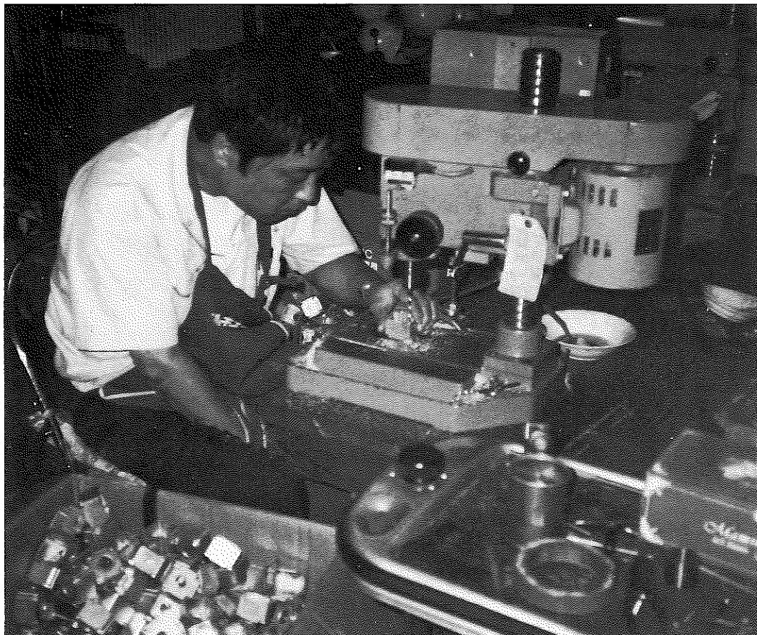
自動卓上ボール盤による機械加工作業(世田谷更生館)
