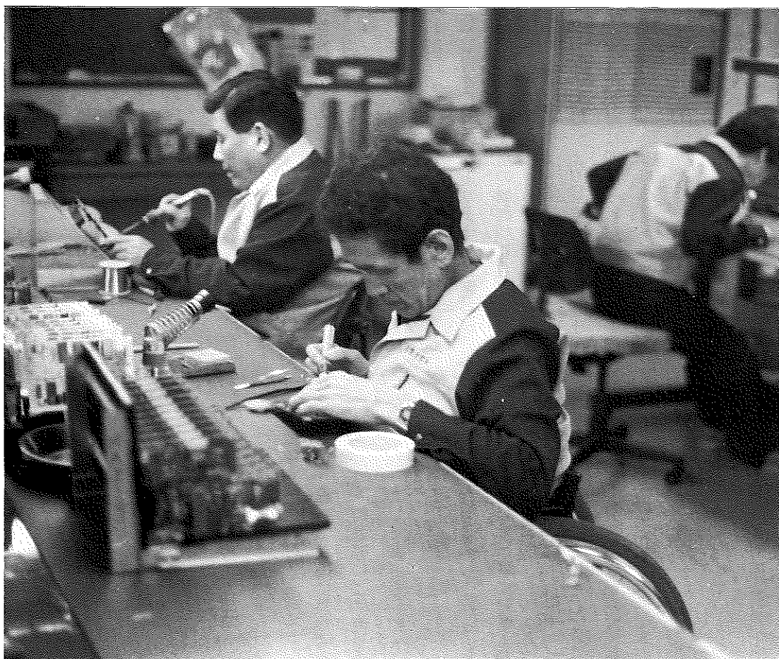
世田谷更生館に於ける通信機器科の基板半田付け作業
